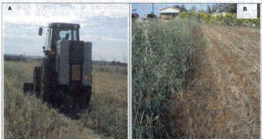
**Figura 3.** Equipamento capaz de produzir descarga elétrica a partir da rotação da tomada de força do trator e eliminar as espécies daninhas. Barra na dianteira para dessecção pré-semeadura (A). Área não dessecada-testemunha (esquerda) e área dessecada (direita) (B).
