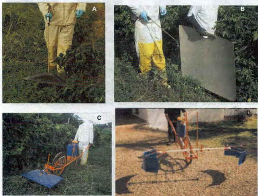
**Figura 5.** Equipamentos para aplicação dirigida de herbicidas: chapéu de Napoleão (A); "mão-baixa" (B); pulverizador "ciclo jet" com protetor para aplicação dirigida (C e D).
