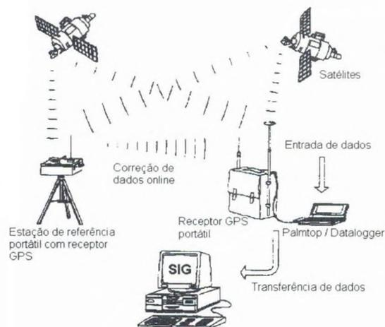
Figura 5 - Sistema de coleta de dados utilizando DGPS portátil <sup>(5)</sup>
