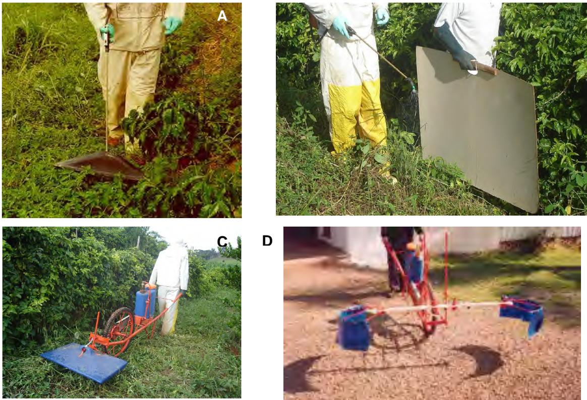
**FIGURA 5** – Equipamentos para aplicação dirigida de herbicidas: chapéu de Napoleão (A); “mão-baixa” (B); pulverizador “ciclo jet” com protetor para aplicação dirigida (C e D).
