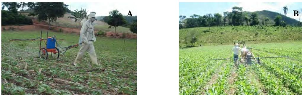
**FIGURA 2** – Pulverizador “ciclo jet” acoplado com barra de quatro pontas de pulverização espaçadas de 1,0 m (A); pulverizador acoplado sobre rodas, tracionado por animal (“carroçajet”) com barra de seis pontas de pulverização espaçadas de 1,0 m (B).
