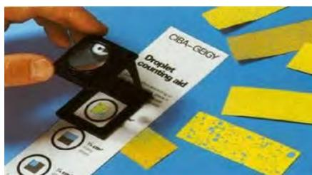
FIGURA 3 - Etiquetas amostradoras usadas na avaliação da cobertura das gotas.
